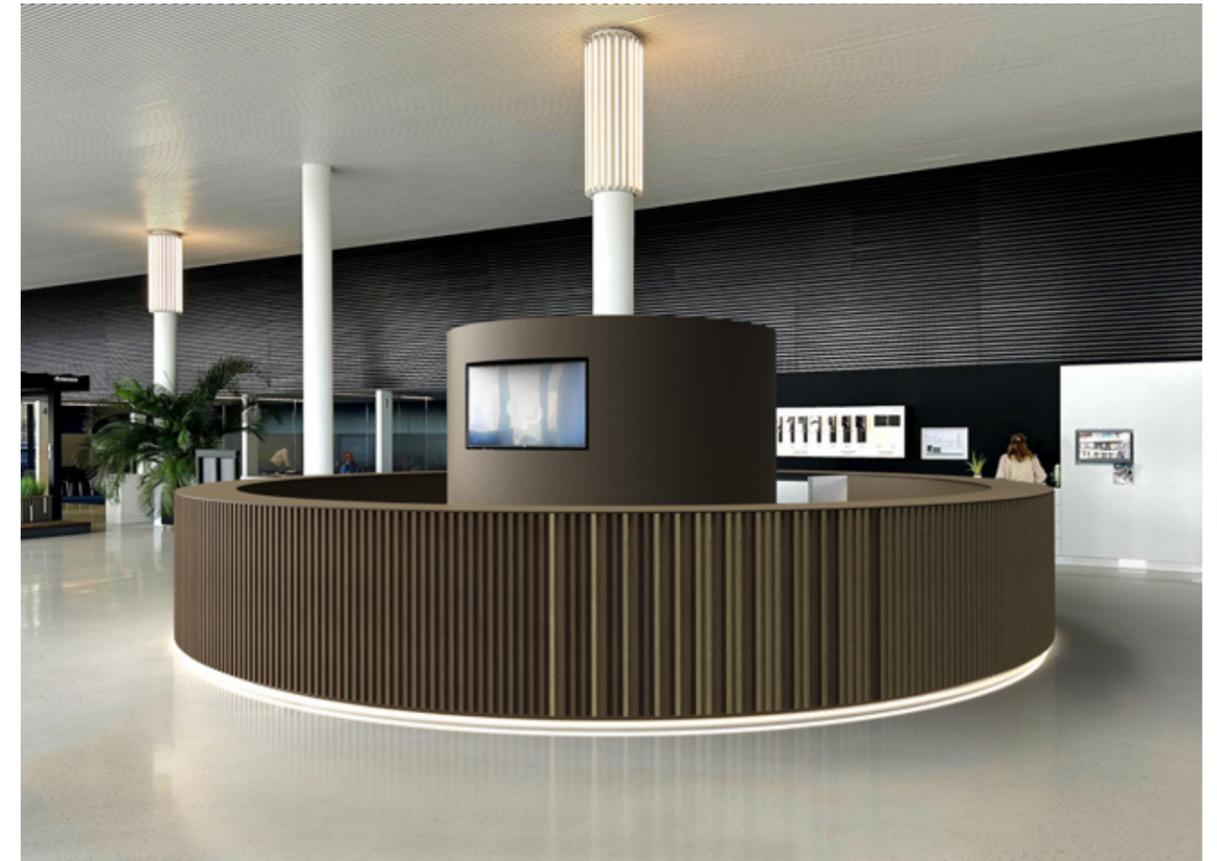
Dank der individuellen Profile ist es in Kombination mit den gebogenen Linarte-Fassadenträgern aus Aluminium sogar möglich, gebogene Fassaden oder Strukturen mit einem Mindestradius von 1.000 mm zu realisieren. Diese Anwendung ist mit allen Profilen möglich. Verarbeitung mit indirekter Akzentbeleuchtung unten erfolgt mit einer LED-Leiste, die im Stützprofil montiert wird.
